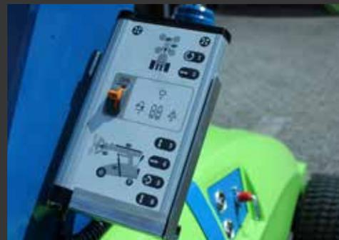
Panneau de contrôle multi-fonctions, simple d'utilisation avec boutons de commande et signaux lumineux, une double sécurité de préhension et une fonction GYRO.
